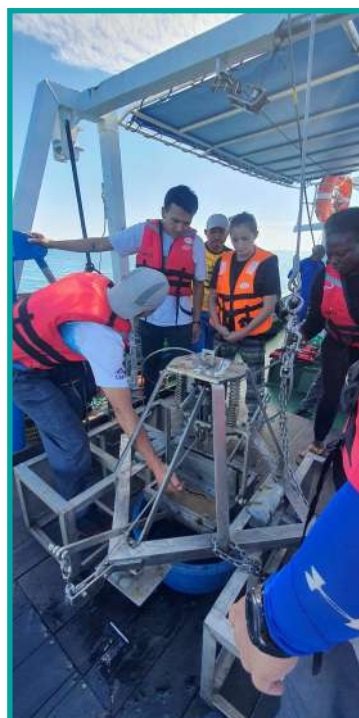
Paparan 15: Pensampel cekau bentos untuk persampelan sedimen laut (ihsan INOS)
