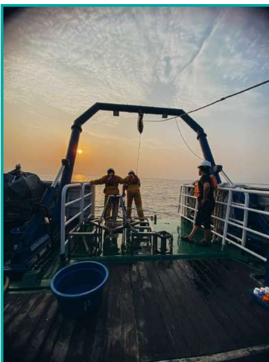
Paparan 14: Pelepasan alat pencerapan profil arus Doppler daripada dek belakang kapal penyelidikan UMT (ihsan INOS)
